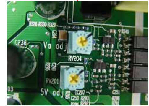
Va, 5V(VCC) Voltage ADJ Va : About 55 ~65 V 5V(VCC) : 5V~5.5V)
